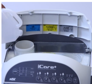
Bild 12 – Påfyllning av olja
